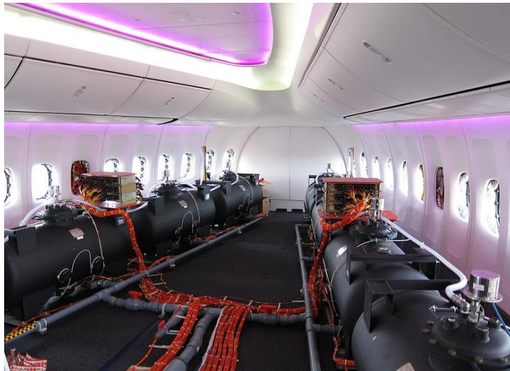
Figura 2: Serbatoi installati su un prototipo di Boeing 747 (25).
